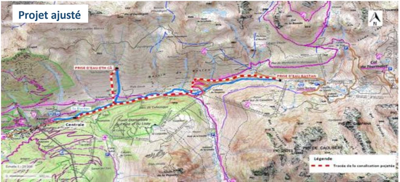
La prise d'eau sur le Bastan de Barèges est à une altitude de 1655 m en aval de la buse du plateau de Caoubère, déplacée environ 100m en aval pour éviter une zone humide en berge. L'inclinaison du seuil de type Coanda est adaptée pour le passage de la faune sauvage. Le débit réservé (50 l/s) représente 18% du module.
